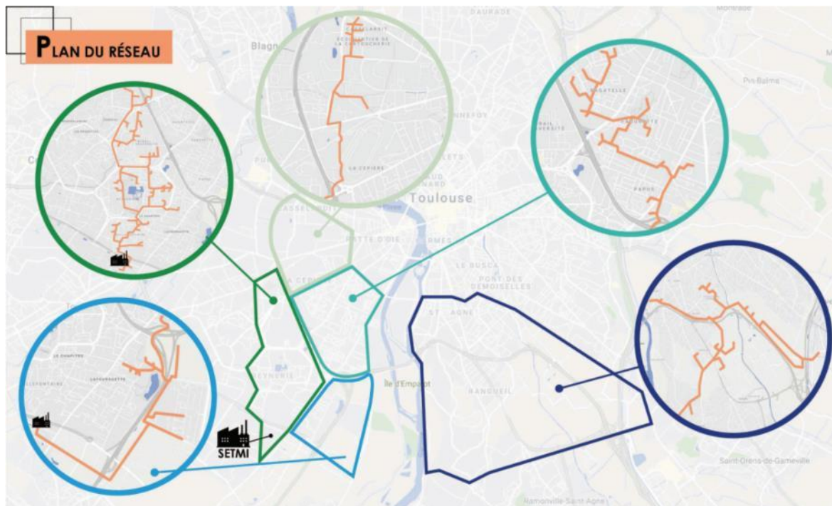
Figure 14 : Carte des réseaux de chaleur alimentés par l'incinérateur (Source : rapport annuel SETMI 2020)
