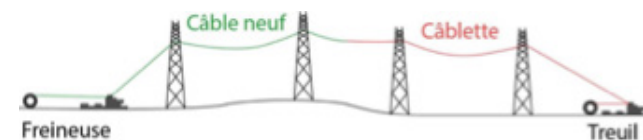
Figure 15. Illustration du principe de déroulage d'un câble
