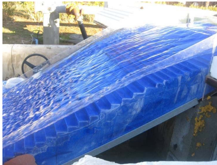
Figure 19 : Ecoulement pour Q=860 \text{ m}^3/\text{s} soit T = 10\,000 ans (source [B9])
